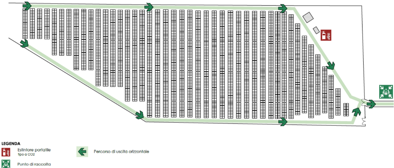
Fig. 2 – Planimetria delle vie di fuga, dei dispositivi antincendio e punto di raccolta
