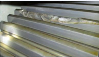
La valutazione visiva è stata fatta mediante un endoscopio dotato di fibra ottica e telecamera: sono stati rilevati danneggiamenti a un dente della ruota dell'albero secondario della pala mentre lo stato dei cuscinetti è risultato essere buono.
