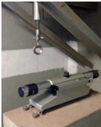
Il secondo sistema di verifica, ausiliario al primo, è la "collimazione" che, partendo da dei riferimenti esterni posizionati sulla collina circostante, verifica gli spostamenti della diga utilizzando una mira mobile posizionata su pilastrini in cemento armato ubicati lungo il coronamento della diga.
